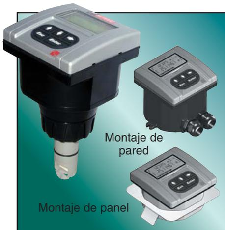
Estos medidores digitales proporcionan información digital de fácil lectura respecto de la velocidad del flujo y el flujo totalizado y pueden transmitir una señal 4 a 20mA proporcional a la velocidad del flujo. La unidad de montaje directo se completa con un sensor integral, mientras que el panel y las unidades remotas de montaje en pared requieren un Sensor FloSite. Ambos requieren una provisión de energía tipo 12-24 VDC.
