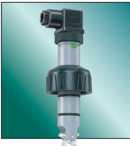
Diseñado para cerrar un dispositivo eléctrico, típicamente una válvula o bomba si el caudal se reduce. Las aplicaciones incluyen una protección de la bomba para que no funcione en seco o que no bombee con la válvula cerrada. Cuando el caudal del sistema cae por debajo de 0.5 pies/seg se activa un disyuntor interno, cerrando así el dispositivo eléctrico. Requiere una provisión de energía tipo 12-24 VDC.
