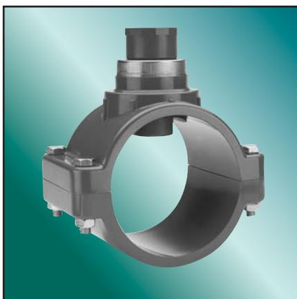
Los accesorios de instalación son utilizados para instalar el instrumental FloSite en los sistemas de cañerías. Dispone de dos tipos de accesorios. Un empalme en T de unión verdadera para cañerías 1/4" a 1-1/2" y espárrago en accesorios de montura para cañerías de 2" a 8". Sellos estándares FPM, opcional EPDM
