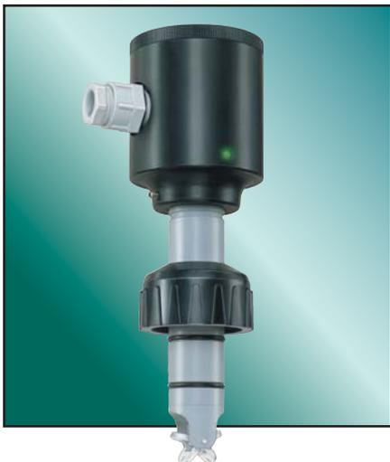
El Transmisor de Flujo Ciego FloSite es ideal para la transmisión de una señal 4 a 20mA proporcional al flujo cuando la indicación visual de la velocidad del flujo no sea requerida y constituye una alternativa eficaz en función de los costos para el Indicador de Flujo Digital/ Totalizador / Transmisor FloSite. Requiere una provisión de energía tipo 12-24 VDC.
