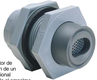
Simplymente suelde el interruptor de vacío en el enchufe de conexión de un accesorio pasachapas convencional Hayward de 1-1/2". Luego instale el empalme de tabique en el tanque. No se requiere cañería adicional. O enrosque directamente en una cañería 3/4".
