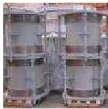
**BISAGRA:** Junta de expansión tipo bisagra ya que por sus componentes hacen esta función de gran capacidad formado por un fuelle equipado con terminales con un sistema de soportes que le permiten movimientos angulares en un solo plano.
