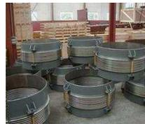
**DUPLEX // UNIVERSAL:** También denominado COMPENSADOR DE DILATACIÓN UNIVERSAL Formado por dos fuelles unidos por un tubo central y extremos para soldar en sus extremos. Absorbe cualquier combinación de los tres movimientos básicos aunque es utilizado principalmente para absorber grandes MOVIMIENTOS LATERALES y puede ser bridada, soldable, y/o combinada.
